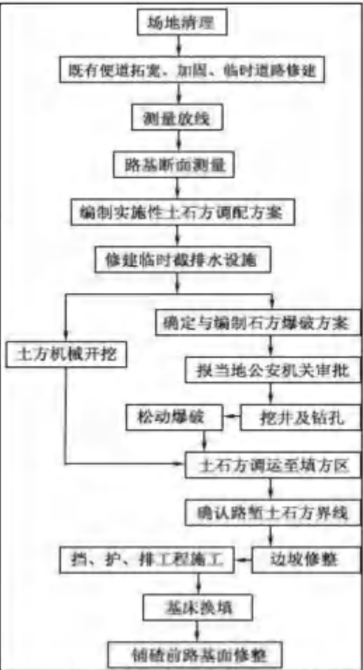
图2.7-2 路堑开挖施工工艺流程
